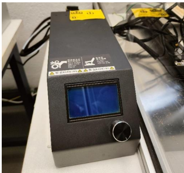
Σχήμα 4. Φωτογραφία του τροφοδοτικού που χρησιμοποιείται για την κίνηση της κεφαλής DBD και της μεταλλικής τράπεζας.
